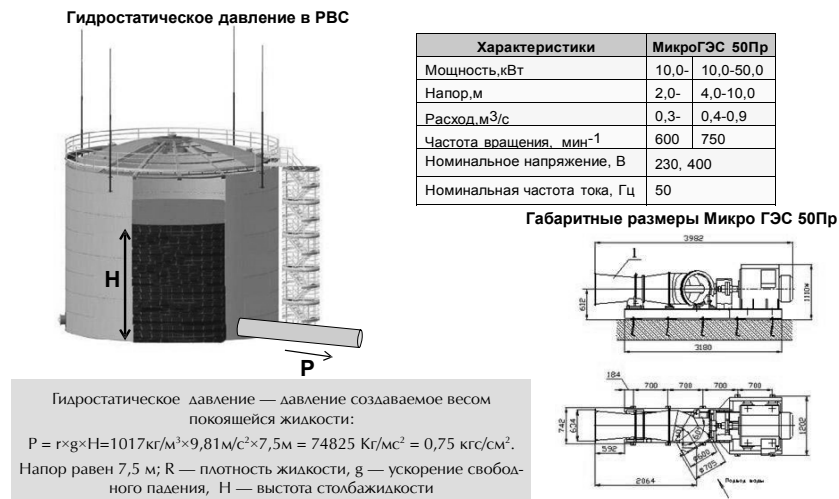
Рис. 2. Монтаж микро ГЭС на участке выхода подтоварной воды с РВС очистных сооружений до НПВ.
