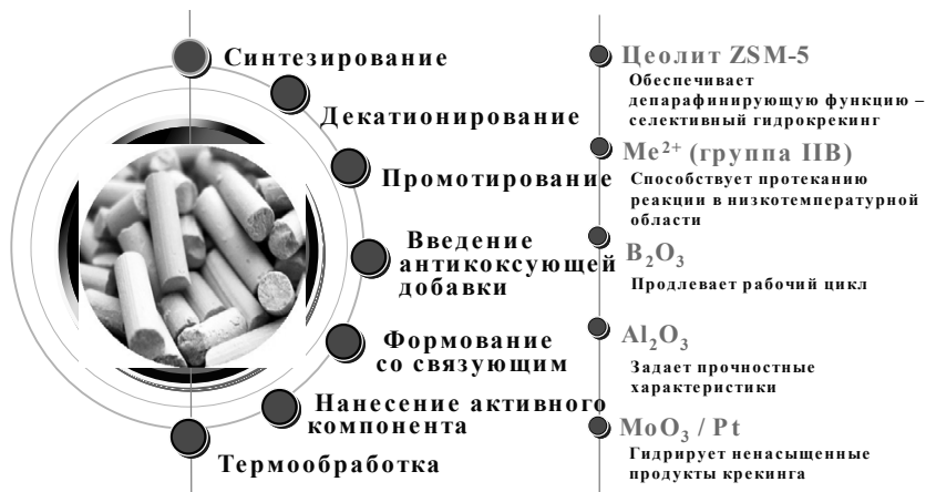
Рис. 6. Стадии приготовления катализатора депарафинизации
