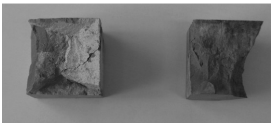
Фото 1. Сравнение глубины проникновения раствора на основе микроцемента (слева) и ПЦТ (справа) в микротрещины цементного камня
