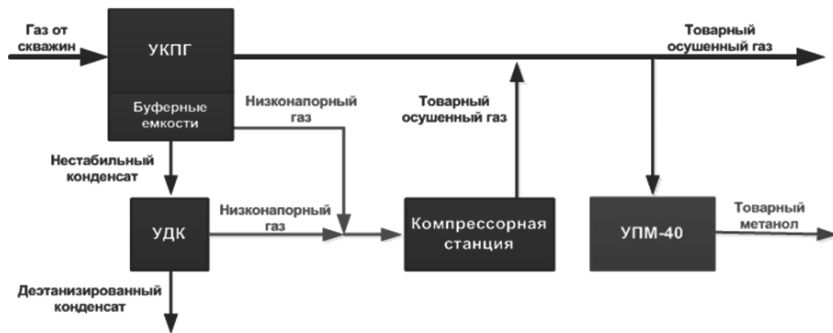
Рис. 1. Принципиальная схема узла газоснабжения УПМ-40
