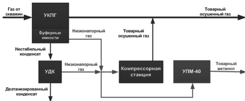
Рис. 2. Принципиальная схема модернизации узла газоснабжения УКПГ и УПМ-40
