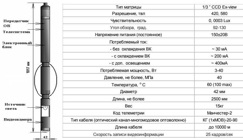
Рис. 3. Технические характеристики скважинного видео комплекса СВК-02
