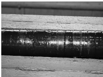
Рис. 3. Рабочие органы насоса ЭЦН в НСЖ
