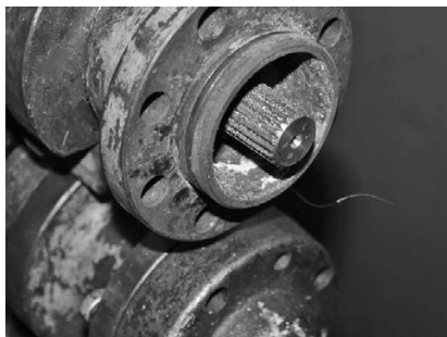
Рис. 4. Отложение солей и наличие накипи на частях ЭЦН
