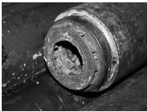
Рис. 5. Неразобранный ЭЦН, при разборке произошло разрушение рабочих органов
