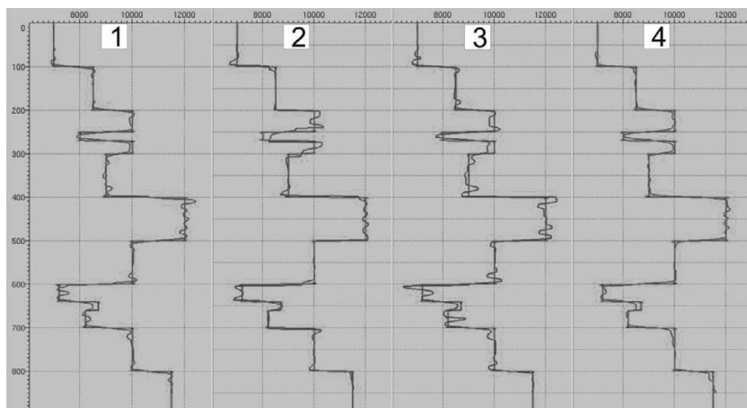
Рис. 3. Результат восстановления распределения акустического импеданса в точке скважины Well4, синим — исходная модель, красным — результат восстановления: 1 — с импульсом по скважине Well1, 2 — с импульсом по скважине Well2; 3 — с переменным интерполированным по скважинам импульсом; 4 — с переменным импульсом ELVI
