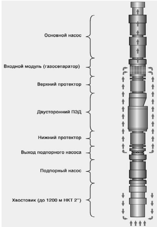
Рис. 2. Состав установки ЗЭЦНДН
