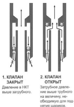
Рис. 5. Принцип работы «КПЭ — 115»
