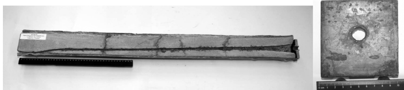
Рисунок 4 Испытание ПМИ-90-02 на керне с металлической пластиной, толщиной 8 мм Диаметр входного отверстия – 17,5 мм, длина канала 800 мм
