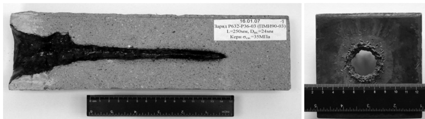
Рисунок 3 Испытание ПМИ-90-03БО на керне с металлической пластиной, толщиной 8 мм Диаметр входного отверстия – 24мм, длина канала 250мм
