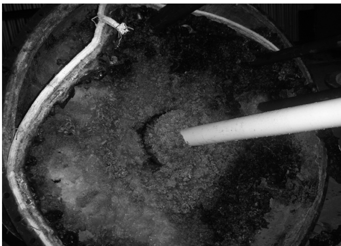
Рисунок 1 - Крышка аппарата позиции 13, которая не была покрыта ингибирующим раствором, после 30 сут непрерывной работы аппарата
