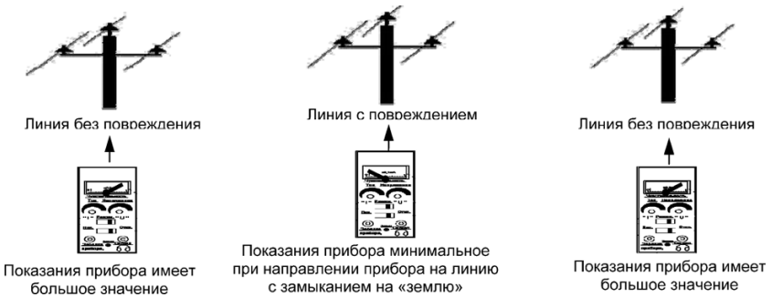
Рисунок №2: Определение линии с поврежденной изоляцией.
