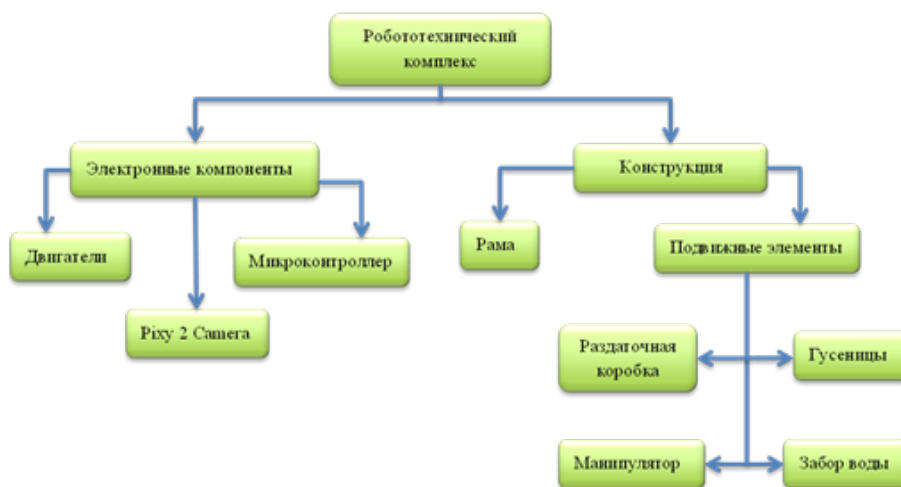
Рисунок 1. Блок схема строения модели робота.
