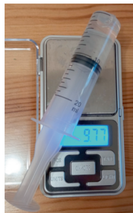
Рис. 3. Взвешивание воды, измещенной оловянным солдатиком. Тара-шприц предварительно учтена на весах.
