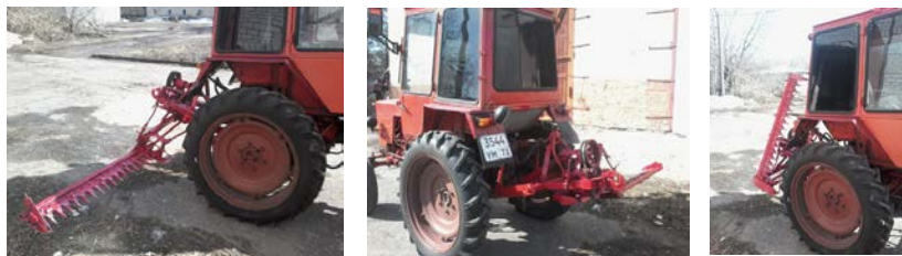
Рисунок 7 – Сегментная косилка для малых фермерских хозяйств
