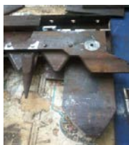
Рисунок 4 – Внутренний и наружный башмак
