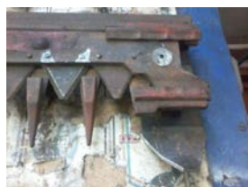
Рисунок 3 – Крепление пальца к брусу
