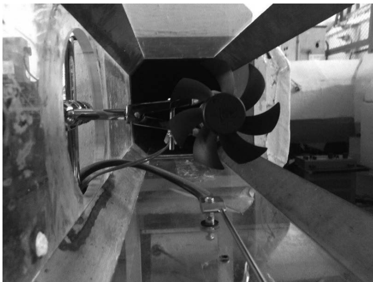
Рис.1 Ветрогенератор в рабочей части аэродинамической трубы МТ-324.
