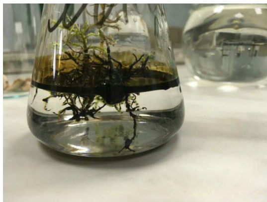
Рис. 1 Исследование поглотительной способности лишайника
